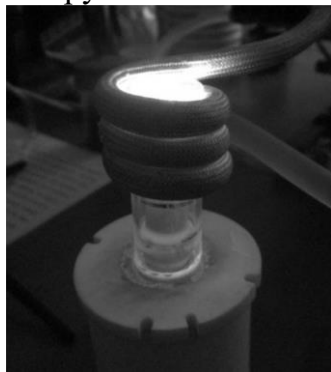
Рис. 1. Индукционный нагрев токами высокой частоты
